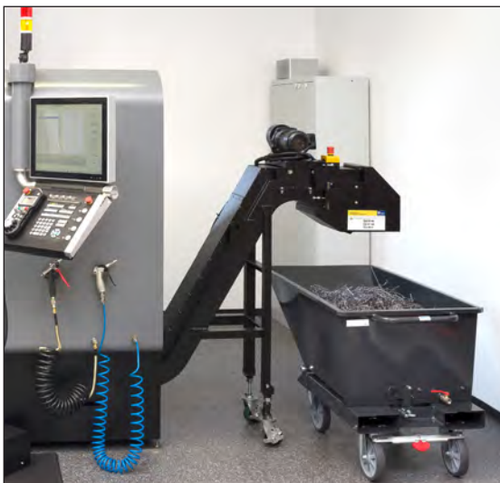
Anwendungsbeispiel: Muldenkipper als Spänebehälter
