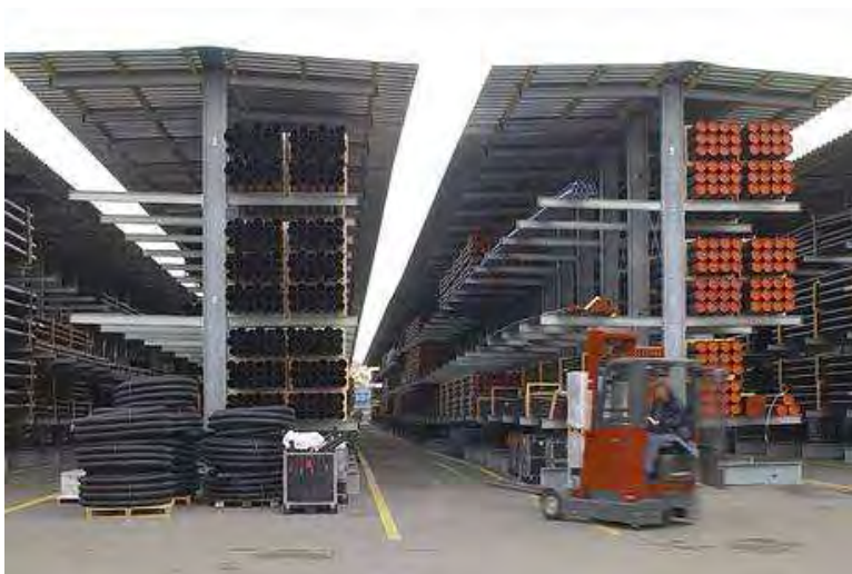
Kragarmregalanlage für sachgerechte Lagerung von Kunststoffrohren
