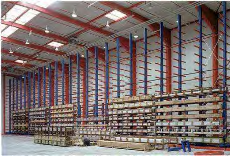
12 m hohe Kragarmregalanlage für Kassetteneinlagerung
